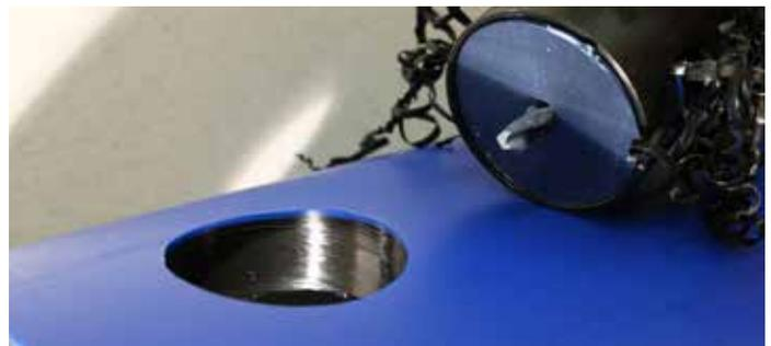
+ optimales Anbohrverhalten und hohe Laufruhe auch bei schrägen Bohrungen unter extremen Winkeln
