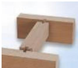
Fazendo o comprimento dos perfils, fresagem das ranhuras e furação para as cavilhas (com ajuda de um gabari ou de uma fresadora/furadora)
