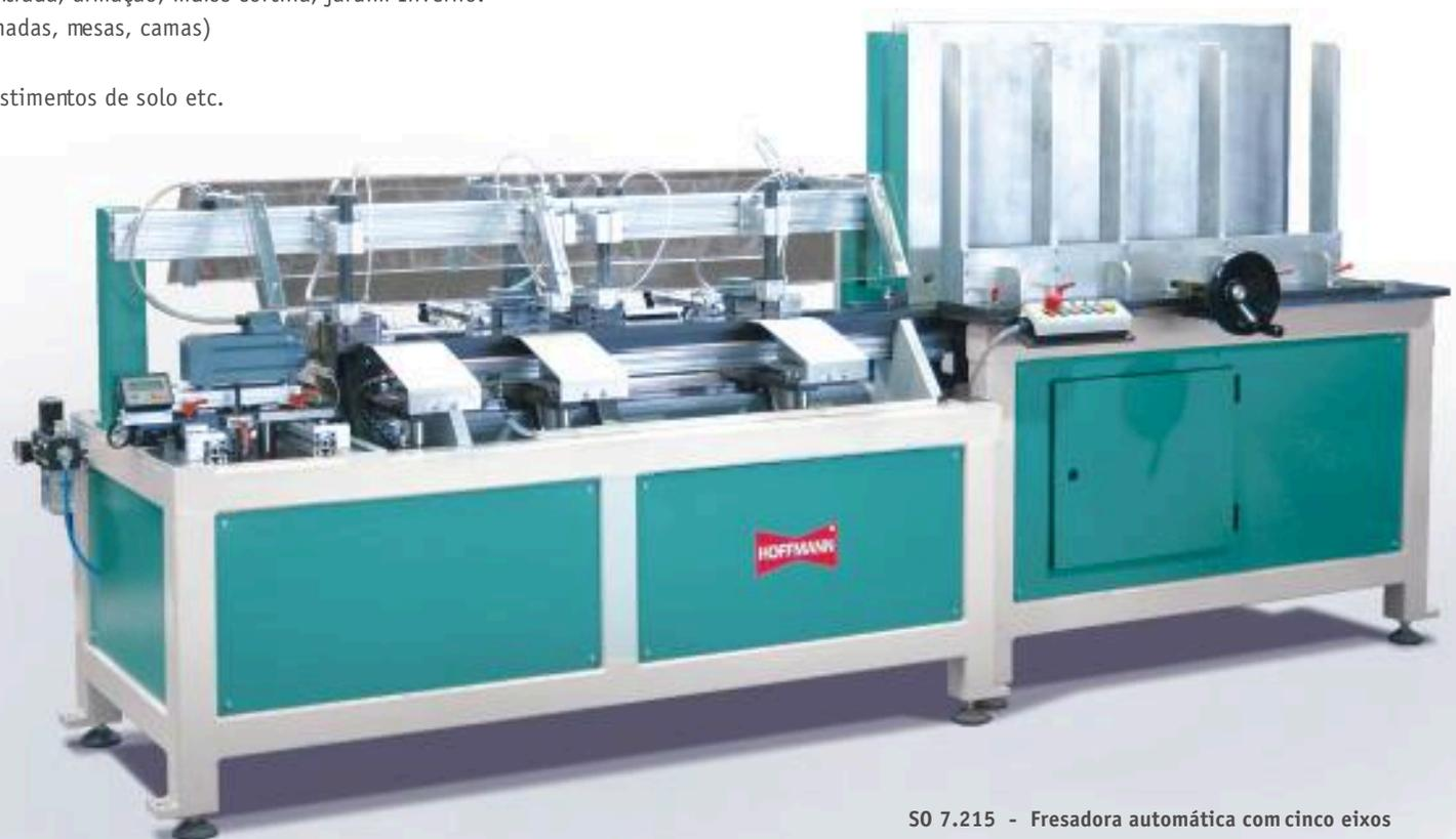
SO 7.215 - Fresadora automática com cinco eixos
