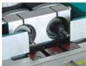
Agregado de fresagem com distância de 65 mm.
