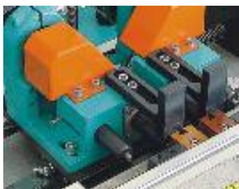
As duas unidades de fresagem têm uma velocidade de rotação de até 34000 t/mn o que permite uma usinagem bem precisa da ranhura.
