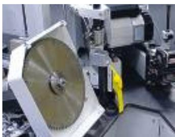
A técnica Hoffmann permite de serrar as peças de 10mm à 600mm de largura. Para nós é muito importante ter um corte preciso sem arrancamento e um ângulo perfeito sobre todo o comprimento de corte. A escolha de lâminas, a velocidades de rotação, e também a localidade de diferentes unidades, são definidas em função dos dados fornecidos pelo cliente. Isso nos permite de responder a suas exigências.
